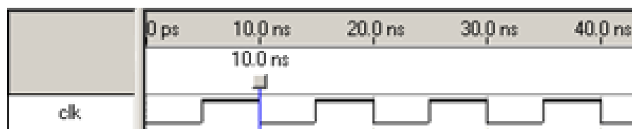
Figura 4.2. Semnale de tact cu perioada de 10 ns.
