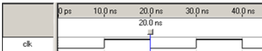
Figura 4.1. Semnal de tact cu perioada de 20 ns.
